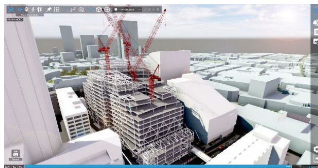
Robert Bird Group의 BIM·4D 시뮬레이션 플랫폼인 Reveal은 클라우드 기반으로 설계·시공을 실시간 탐색·분석·시뮬레이션해 공정 충돌을 예방하고 의사결정을 가속화함
