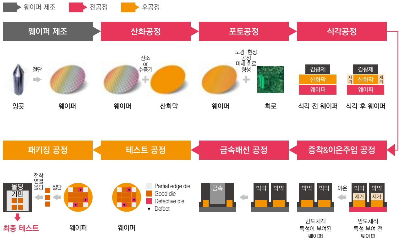
웨이퍼 제조의 경우, 실리콘 잉곳(Ingot)의 제조와 이를 절단, 연마, 세척하여, 최종 검사를 통해 웨이퍼를 생산하는 공정을 의미한다. 잉곳은 웨이퍼로 제조되기 전의 실리콘 기둥으로, 이를 절단하여 반도체의 기초 제조인 웨이퍼를 생산한다. 이러한 웨이퍼 제조 공정을 통해 생산된 웨이퍼는 산화-포토-식각 공정을 거쳐 회로가 주입된다. 산화공정은 웨이퍼 표면에 산화막을 형성하는 과정으로, 산화막은 이후 과정인 식각 및 이온 주입 과정에서 방지막 역할을 수행하여, 웨이퍼가 설계된 회로 대로 제조될 수 있도록 한다. 포토공정은 웨이퍼에 회로를 그려넣는 과정으로, 감광액 도포 후 노광, 현상하는 방식으로 진행된다. 식각 공정에서는 포토공정에서 입혀진 감광액을 제외한 부분을 깎아내게 되며, 이후 증착 및 이온주입공정을 통해 전기적 특성을 부여하게 된다 (8대 공정에 포함되어 있지는 않지만, 산화-포토-식각 과정에서 발생하는 불순물을 제거하기 위한 세정 공정을 거친다.)
