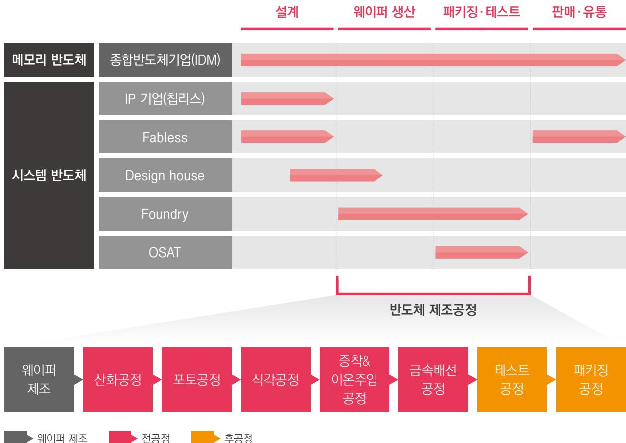
반도체는 크게 메모리 반도체와 시스템 반도체(비메모리 반도체)로 분류되며, 설계, 웨이퍼 생산, 패키징 및 테스트, 판매 및 유통과정을 거쳐 소비자에게 판매된다. 메모리 반도체의 경우 IDM(Integrated Device Manufacturer, 종합 반도체 기업)이 상기 4가지의 과정을 모두 수행하며, 시스템 반도체의 경우 각 절차가 비교적 전문화되어 있는 경향을 보인다. 이 중 설계단계는 흔히 펩리스(Fabless)라 불리는 설계 전문 기업에 의해 진행되며, 설계가 완료된 이후 생산을 전담하는 파운드리(Foundry) 기업으로 넘어가 판매 유통과정을 거치게 된다.
