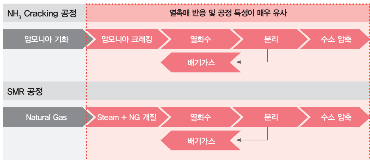
그림 7. 암모니아 크래킹 공정과 SMR 공정의 비교
