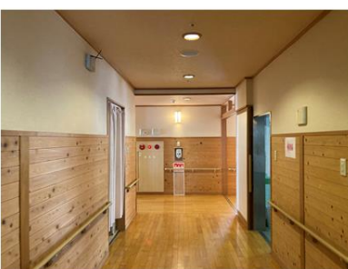
消火栓も壁に溶け込むよう、デザインを木目調にしている。
