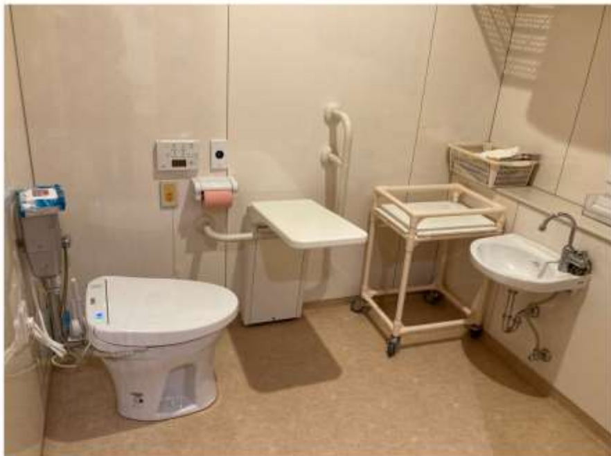
全てのトイレに可動式の補助テーブルを設置。姿勢を支えたり、前傾姿勢を取る際に使用することで、立ち上がり動作を補助する。
