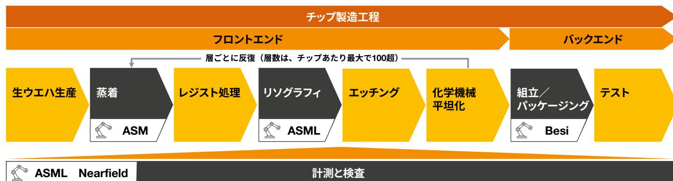
図表4 チップ製造工程の概略と、オランダの主要な機器関連企業の役割
