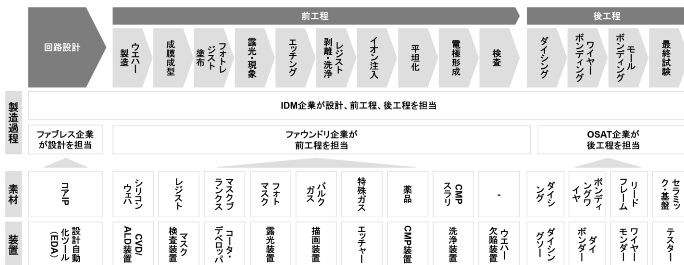
図表1: 半導体製造過程の構図
