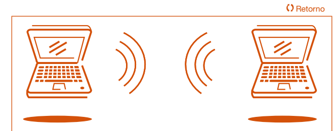
Figura N° 3: Topología de red inalámbrica “ad hoc”
